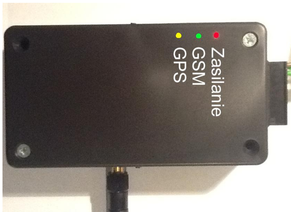
Rozmieszczenie lampek sygnalizacyjnych na obudowie
